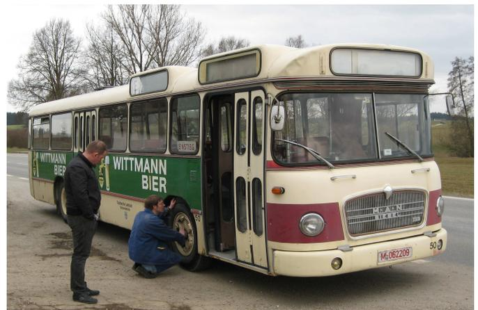
Zwangshalt: mit heiß gelaufener Bremse an der Vorderachse muss die Fahrt 25 km vor dem Ziel unterbrochen werden – zum Glück nur für etwa 2 Stunden! Der Landshuter Metrobus erreichte seine Halle in Dingolfing dann ohne weitere Schwierigkeiten.
