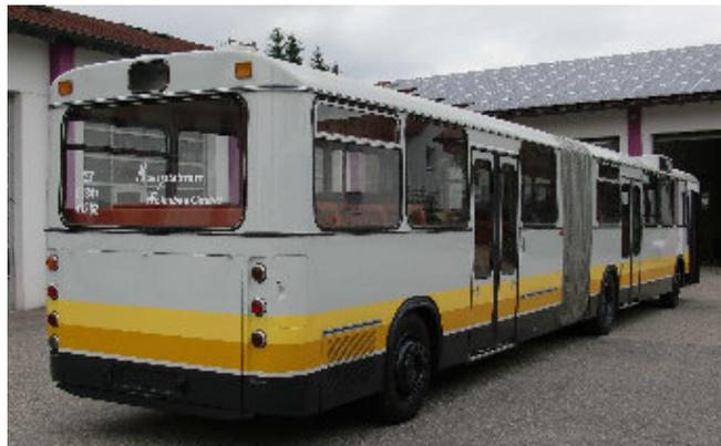
Bei den ersten Prototypen des SG 240 H wurden noch runde Rückleuchten verwendet – serienmäßig hatte dieser Fahrzeugtyp die moderneren, eckigen Rücklichter.
