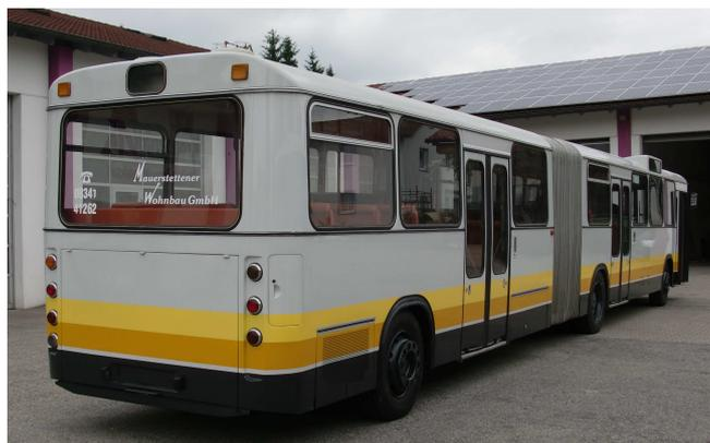
Bei den ersten Prototypen des SG 240 H wurden noch runde Rückleuchten verwendet – serienmäßig hatte dieser Fahrzeugtyp die moderneren, eckigen Rücklichter.
